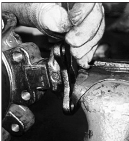
图2 - 从阀板凸缘上部如何将上阀杆拆卸下来
